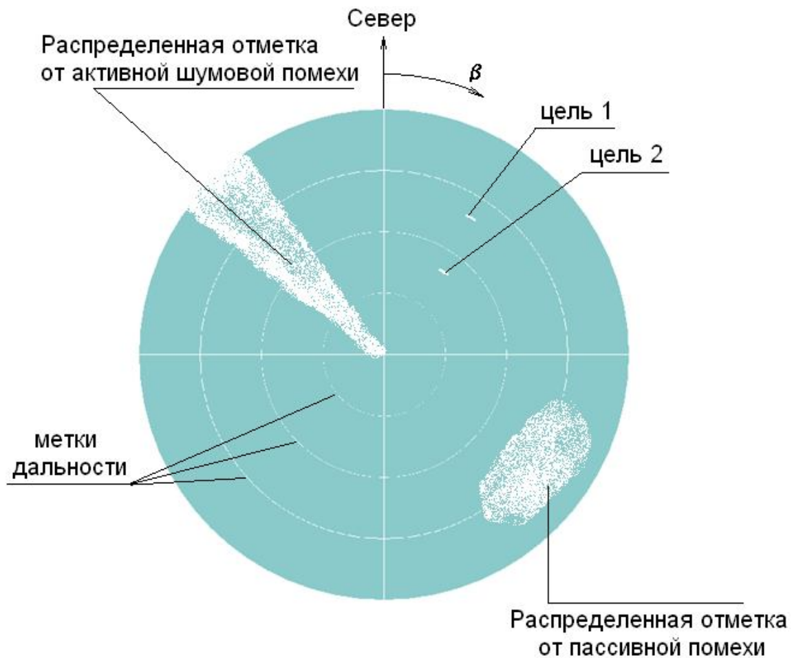
Рис. 17. Сосредоточенные и распределенные отметки на экране индикатора кругового обзора.
